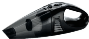
NR9399, 2903992 ABS+PP材质 功率60W 输入 12V/5A 噪音 < 80分贝 带 2.7米长供电线 携带方便
